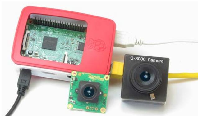
Bild 2: Raspberry Pi 3 mit O-3000 Kamera.
